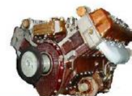
Двигун УТД-20 ремонт
